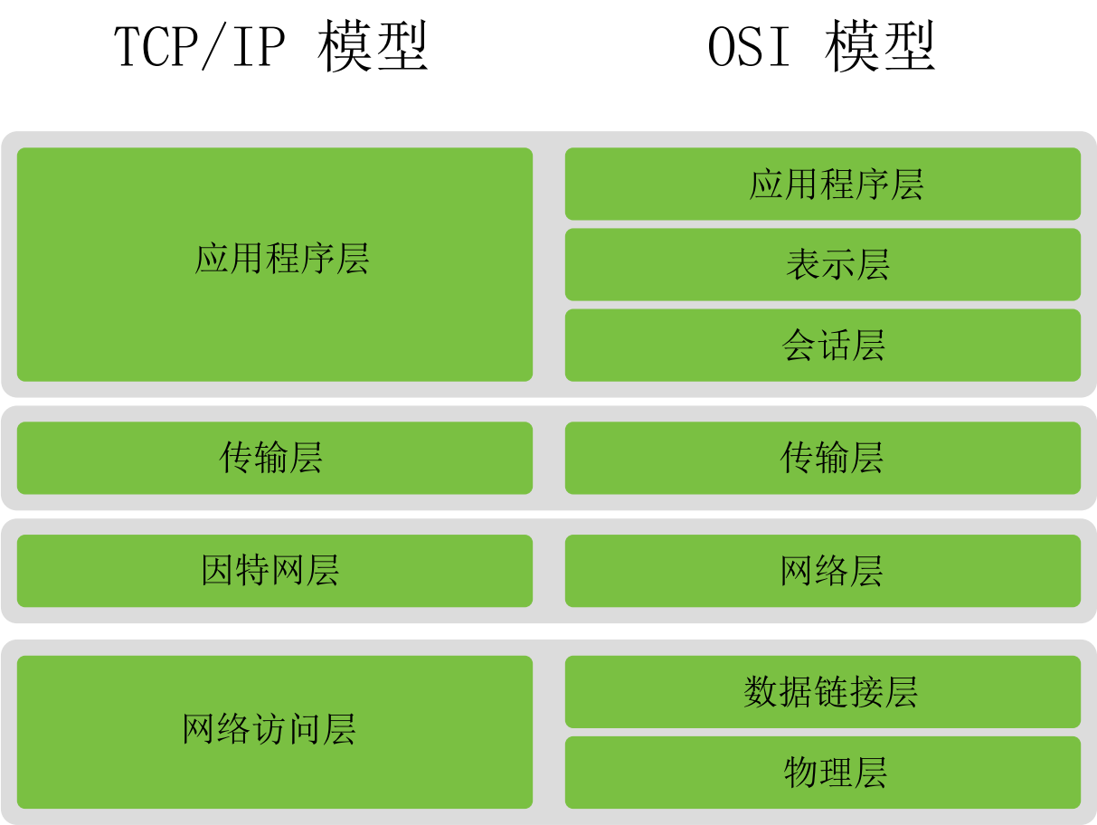
图 19.1 TCP/IP 的简化层次模型
